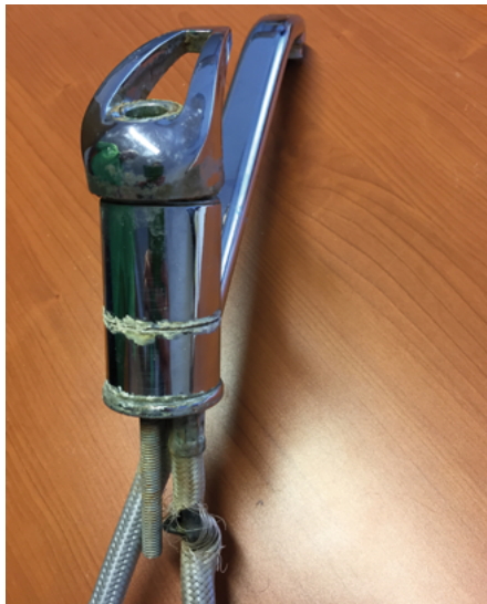
Defekter Anschlusschlauch einer Billigarmatur (Mischbatterie in der Küche)
